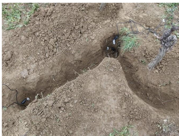
Slika 2. Upotreba kapacitivnog senzora za ispitivanje ponašanja vode u tlu – OG OFIVO
