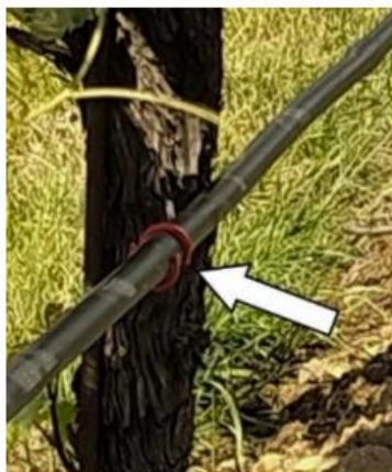
Slika 5. Stezaljke (hydro-clips) koje se stavljaju na kapaljke i zatvaraju ih radi moduliranja pomaka i promjenjivosti brzine kapanja – OG VIRECLI
