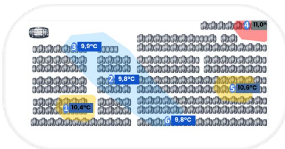
Slika 3: Uporaba karte podruma za utvrđivanje mikroklima kojima se optimizira gubitak isparavanja i štedi energija 17
