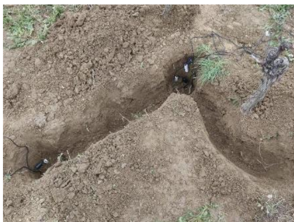
Slika 4. Upotreba kapacitivnog senzora za ispitivanje ponašanja vode u tlu – OG OFIVO
