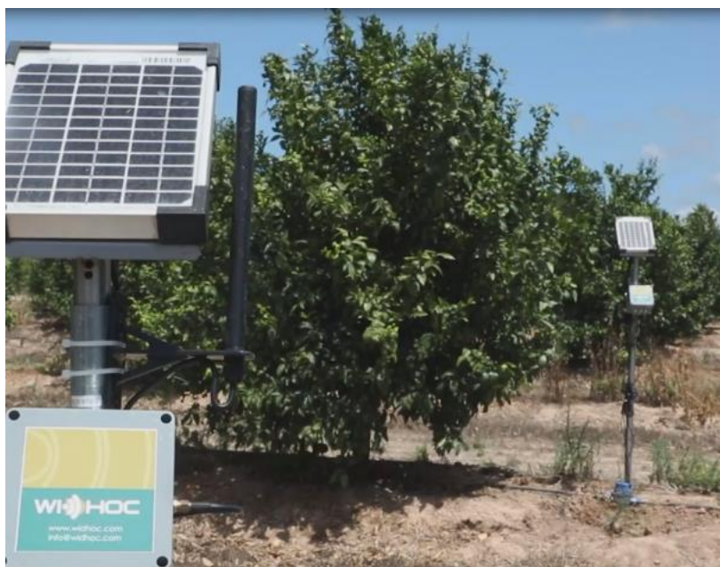
Slika 10. Kapacitivni senzor u nasadu citrusa slično primjenjenom od OG GO AVOCADO
